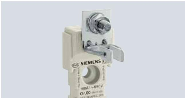
Плоский зажим с винтом предназначен для подключения шин или кабельных наконечников. Он имеет фиксацию от проворота винта с уплотнительной и пружинной шайбой и гайкой. При затягивании гайки необходимо соблюдать момент затяжки из-за значительного влияния рычага. Двойное присоединение отличается от плоских зажимов тем, что над и под плоским зажимом может располагаться по одной сборной
